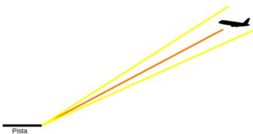
Figura 2 Representação simplificada do glideslope , a rampa ideal de descida
